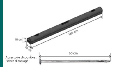
Nous proposons des fiches d'ancrage en complément. Celles-ci sont nécessaires à la fixation des bûtées de parking dans le sol (voir guide d'installation).
